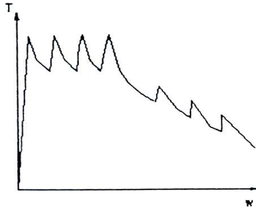
شکل (۲-۳) چگونگی تغییر گشتاور موتور بوسیله مدار کنترل مقاومتی
