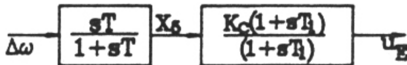
شکل (۲-۳) - بلوک دیاگرام PSS
