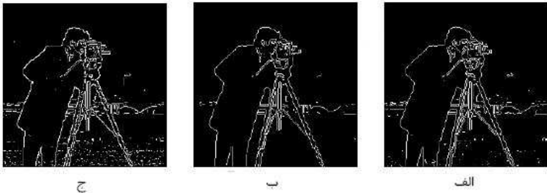
آشکارسازی لبه توسط روش های مختلف، با سطح آستانه ۰/۱۴، الف- روش Sobel، ب- روش Prewitt، ج- روش Roberts. مقادیر روشنایی بین صفر و یک می باشد.
