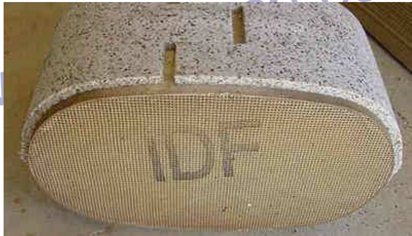
ساختار کاتالیزور لانه زنبوریِ سرامیکی
