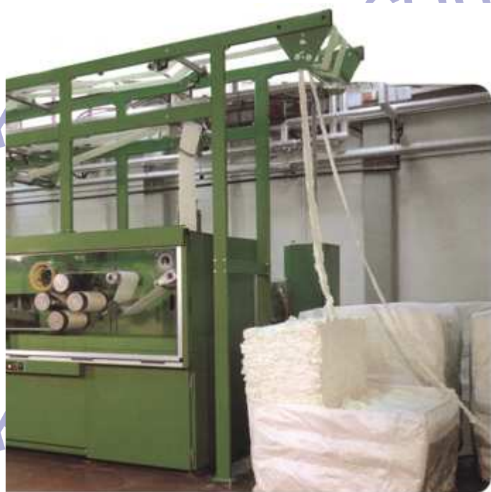
ماشین توبه تاپس (توبریکر) ساخت کمپانی (COGNETEX) ایتالیا
