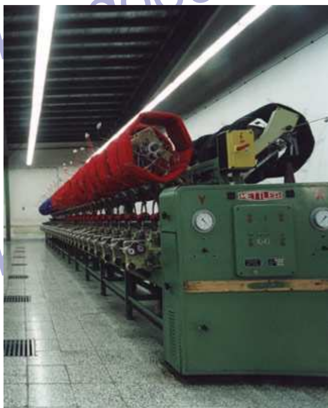
ماشین های دوک بیچی ساخت کمپانی (metler) سوئیس
