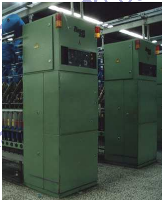
ماشین رینگ ساخت کمپانی زینسر (zinser) آلمان
