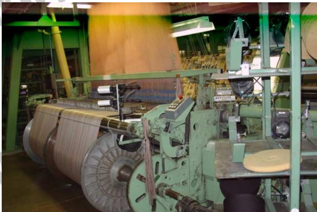
پارچه توسط ماشین بافنگی بافته می شود. برای انجام این مراحل، نخ دسته اول معین تار بر روی غله طک نخ تار و نخ دسته دوم بر روی ما سوره نخ پود پیچیده می شود و هر دو دسته نخ در ماشین
