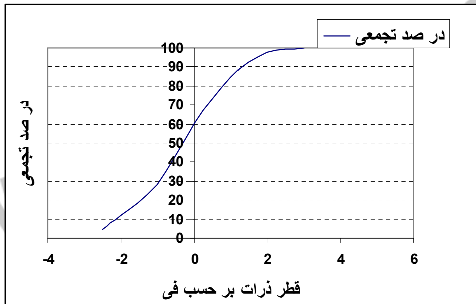
شکل ۴-۵: منحنی فراوانی تجمعی دانه بندی نمونه شماره ۴ در مقیاس فی
