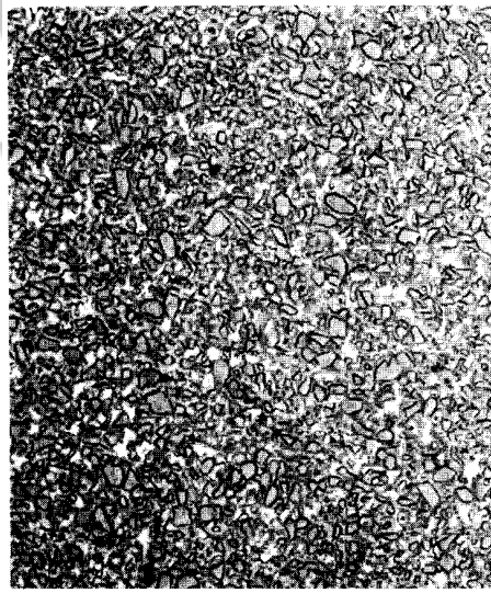
شکل ۲۵: میکروساختار یک نمونه اسپینودال سرمت کربونیتیرید تیتانیم. فرآیند ساخت، به حداقل رساندن اندازه دانه و بطور موافق تولید کردن ماده بدون تخلخل، تجزیه اسپینودال نامیده می شود.
