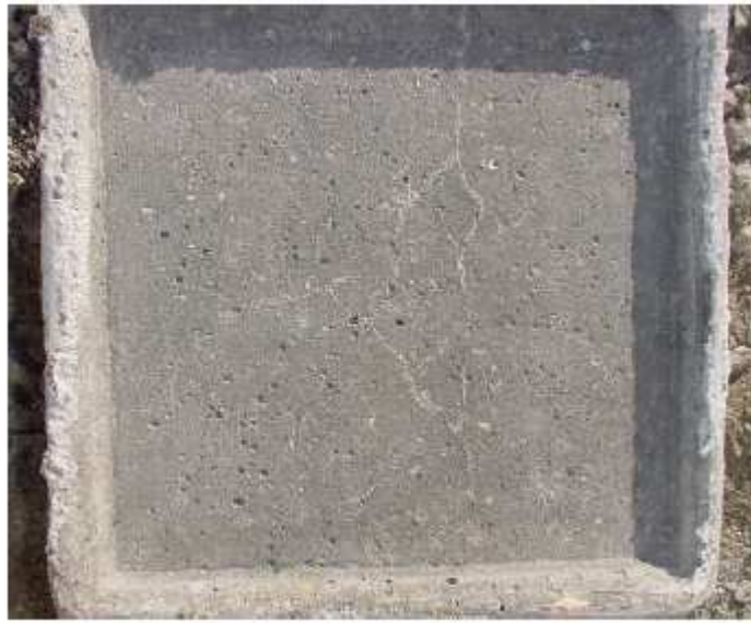
SE - CRPT1 / N-3 -۲-۳۸ ضخامت ترک بر روی نمونه
