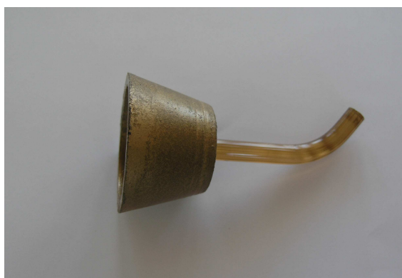
تصویر ۲-۳: فیبر نوری که در قسمت سر دستگاه کالریمتر نصب گردید
