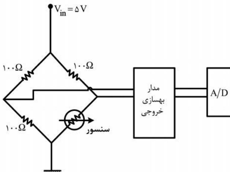
(۱) تقویت‌کننده با گین تقریبی  $10^0$  و مدار تنظیم سطح DC تا ۱ ولت
