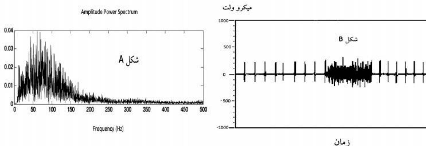
(۱) شکل A طیف قدرت مربوط به سیگنال EOG و شکل B سیگنال ECG به همراه سیگنال EMG
